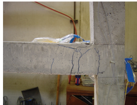
(d) Cracks at region D
