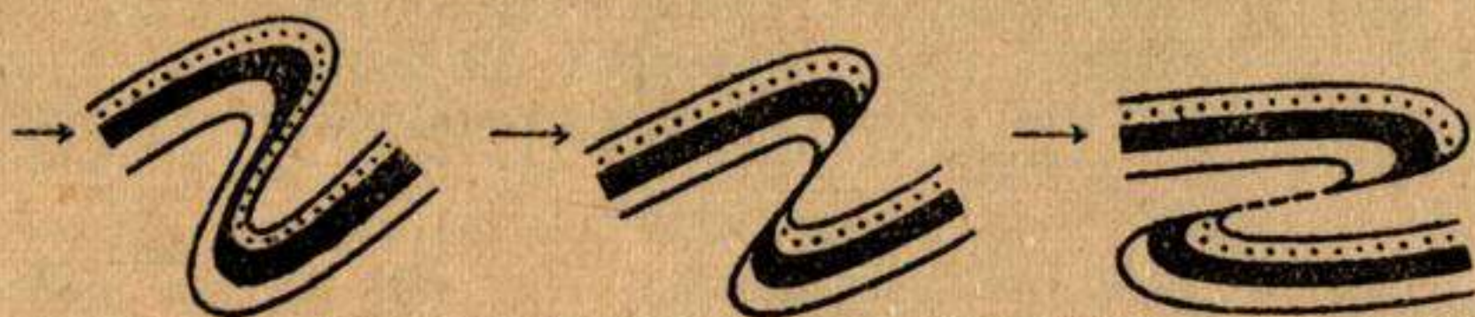
Fig. 11.—Transformación de un pliegue inclinado en pliegue-falla y corrimiento por presión unilateral.
