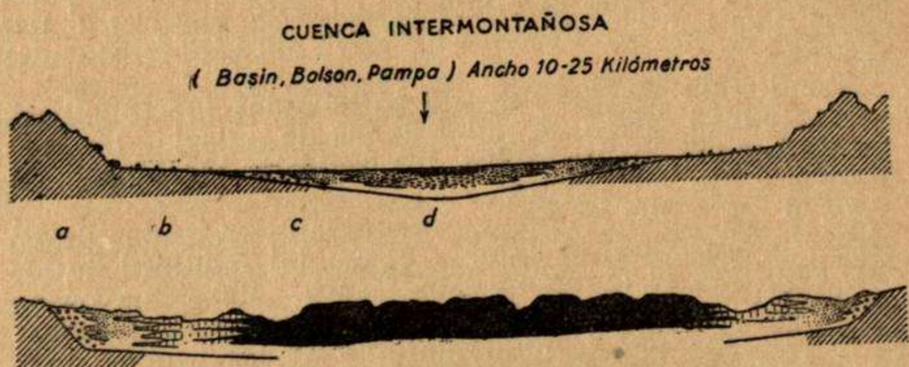
Fig. 35.—Corte esquemático de cuencas endorreicas. I, Bolsón mejicano; el tamaño de los derrubios disminuye hacia el centro. II, Depresión de Calatayud; la parte en negro representa los depósitos salinos (Brinkmann).
