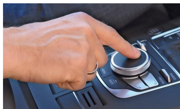
Abbildung 6-5: Touchpad auf der Oberfläche des Dreh-Drückstellers zur Eingabe von Schrift und Zahlen in einem Audi A3. Abbildung von i.computer-bild.de (2013).
