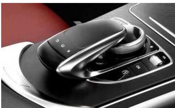
Abbildung 6-4: Touchpad zur Eingabe von Schrift und Zahlen sowie zum Steuern des Infotainmentsystems in einer Mercedes C-Klasse. Abbildung von www.handelsblatt.com (2013).
