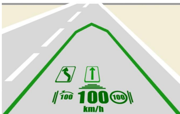
Abbildung 4-9: Kontaktanalogenes Head-up-Display der Gestenerkennung und des taktilen Touchdisplays während der Fahrt mit aktiviertem Conduct-by-Wire .
