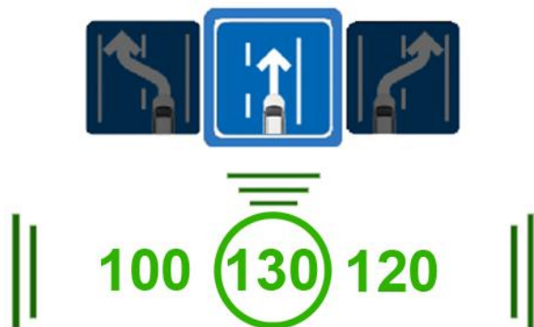
Abbildung 4-1: Head-up-Display während der Fahrt mit aktiviertem Conduct-by-Wire (manöverbasierte Fahrzeugführung) (nach Franz et al., 2011).
