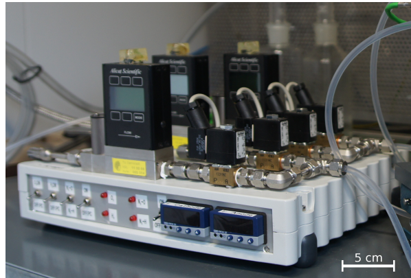
Abbildung 3.1.: Abbildung des Teststandes mit Ventilen, Massenflussreglern und Temperatursteuerung.
