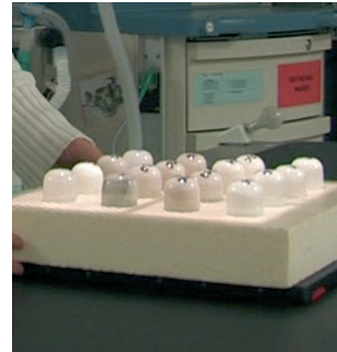
Abbildung 10: Positionierung der Drogenpäckchen auf der Röntgenkassette senkrecht zum Strahlengang
