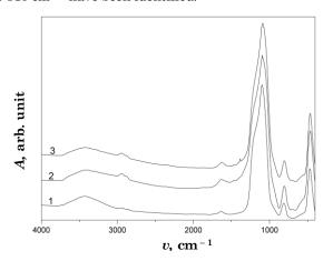
Fig. 2 – FTIR spectra of  $SiO_2$  (1),  $SiO_2$ -APS (2) and  $SiO_2$ -APS-AgNP (3)
