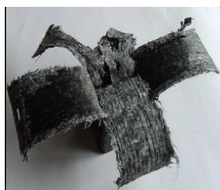
Rajah 2.11: Ubah bentuk pada tiub (Zarei et al, 2010)
