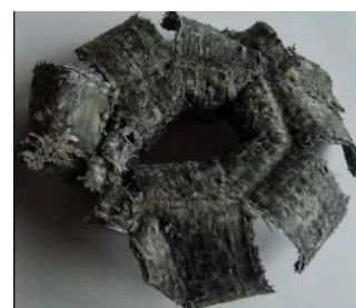
Rajah 2.11: Ubah bentuk pada tiub (Zarei et al, 2010)
