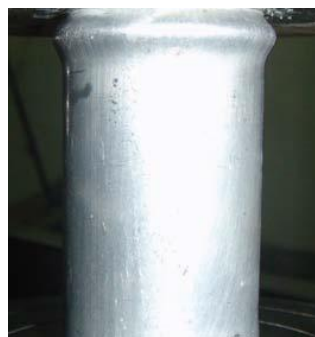
Rajah 2.9: Ubah bentuk aluminium berisi buih (Liu et al, 2012)
