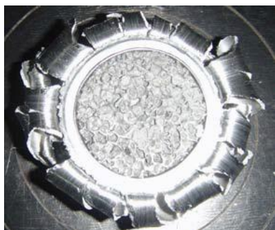
Rajah 2.9: Ubah bentuk aluminium berisi buih (Liu et al, 2012)
