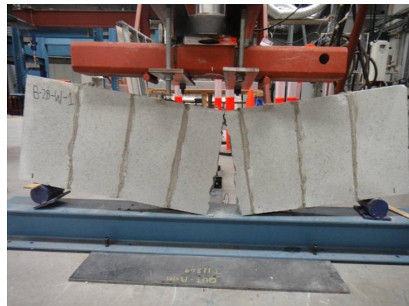
(d) Beam (block failure)
