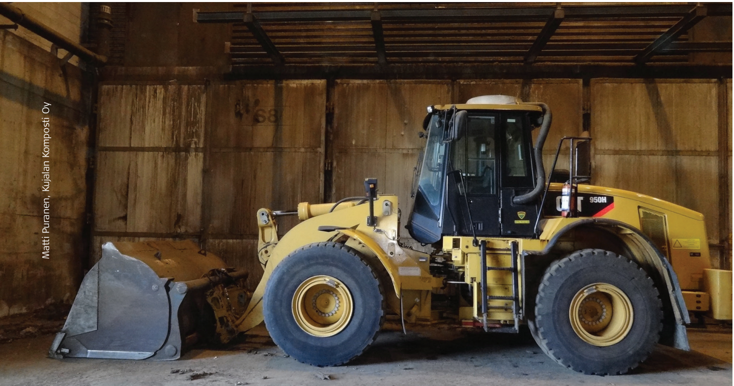
Ohjaamon ilmansuodatusjärjestelmä asennettuna työkoneen katolle.
