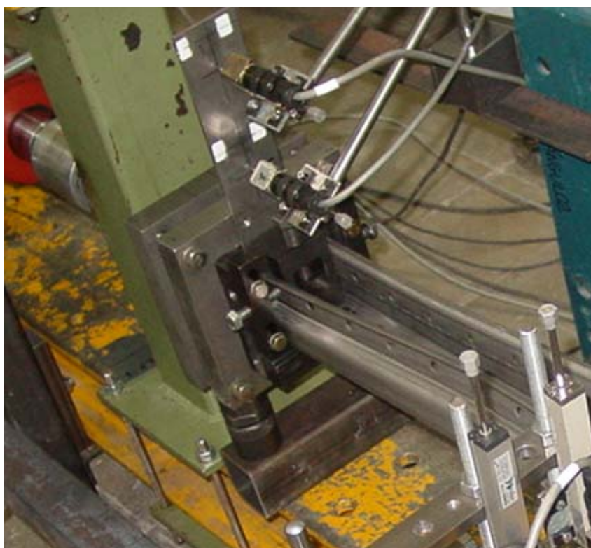
Fig 4.3 Detall de la unió placa-puntal per reproduir un encastament del perfil
