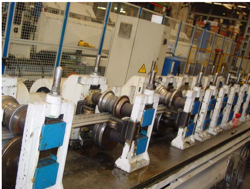
Fig 3.3 Estacions de rodets d'una línia de fabricació
