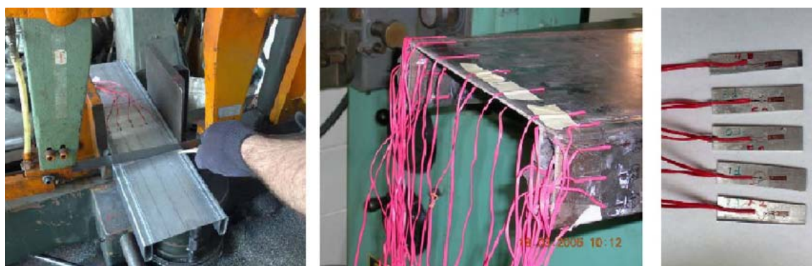
Fig 3.27 Procés per tal d'obtenir les tensions residuals longitudinals. Font: [84]
