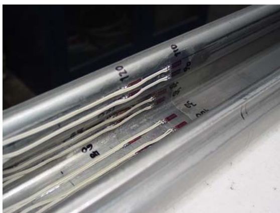
Fig 4.8 Muntatge experimental. Vista de les galgues situades a la cara interior
