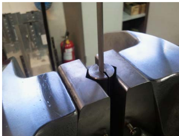
Fig 4.21 Detall de l'utilatge dissenyat per realitzar l'assaig de les provetes corbades
