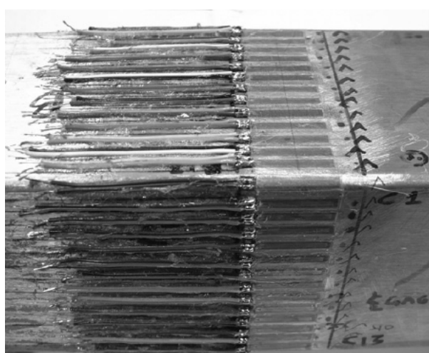
Fig 3.28 Col·locació de les galgues al llarg del desenvolupament del perfil. Font: [83]
