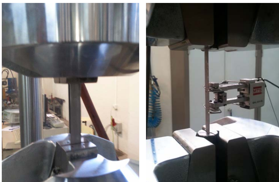
Fig 4.20 Assaig de les provetes planes (esquerra) i corbades (dreta)
