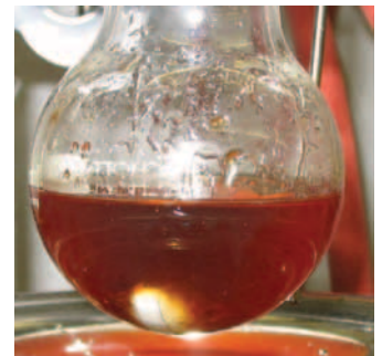
Ionisk væske. Træspåner (øverst) bliver opløst i en ionisk væske ved opvarmning til 100 °C. Billederne viser reaktionen efter 1 time (midten) og efter 5 timer (nederst).
