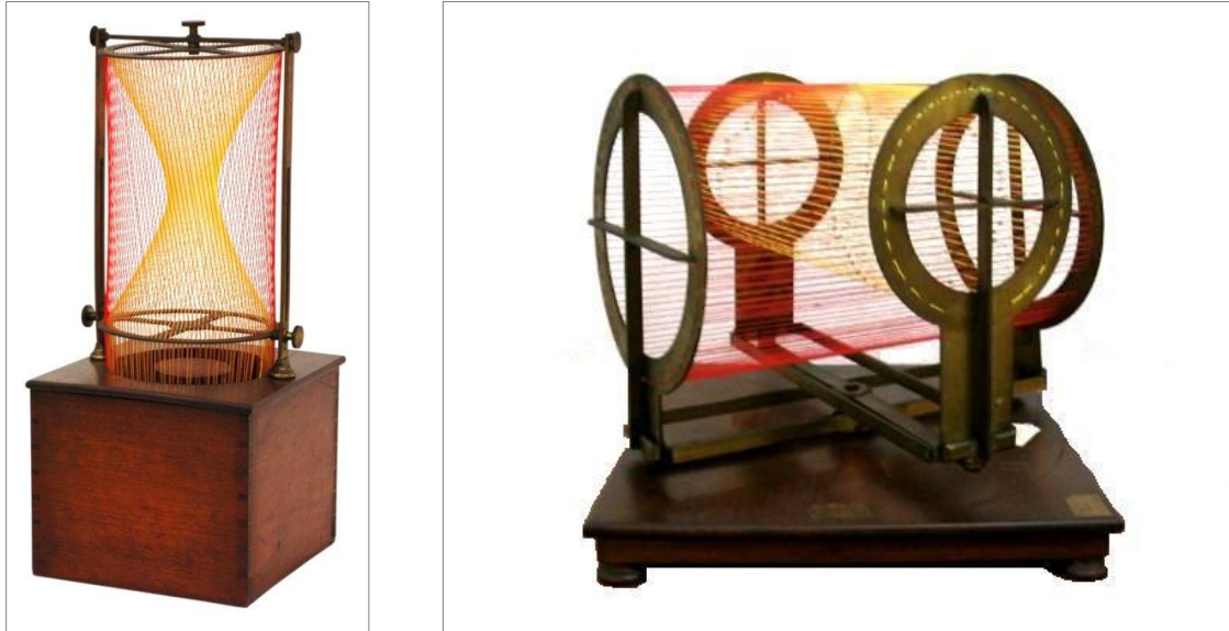
Figura 4.26 – Modelo de transformação de um cilindro num hiperboloide de uma folha; N° de inventário - MPL312OBJ; Museu do Instituto Superior de Engenharia do Porto
