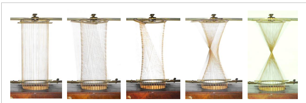
Figura 4.16 - Conjunto de figuras que ilustram o modelo de transformação de cilindro a hiperboloide de uma folha a cone assintótico e paraboloides tangente. Superfícies regradas, 1861; Fabre de Lagrange, Paris; Museu de Ciência da Universidade de Lisboa; N° de Inventário MCUL 1127
