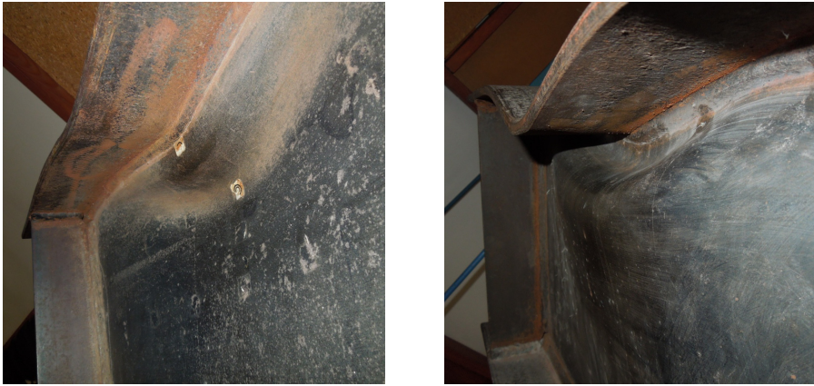
Obr. 7: Plastizace stojiny – výsledek experimentu
