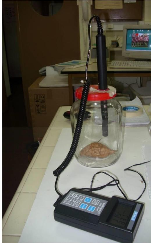
**Figura 1.4.** Sensor Compuflow 8650 Indoor Air Quality Meter empleado en la medición de la actividad respiratoria de raíces de *Pachyrhizus ahipa* (ahipa).
