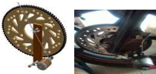
Gambar 8 Pemasangan dinamo sepeda di cakram sepeda motor dengan isolasi kasar.
