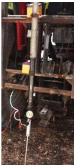
Figure 4: Kit de mesure de pénétromètre vertical muni de capteur électronique de mesure de pression et de système d'acquisition (gauche) et courbe de calibration de force de pénétration \text{Bar} = f(V) (droite)
