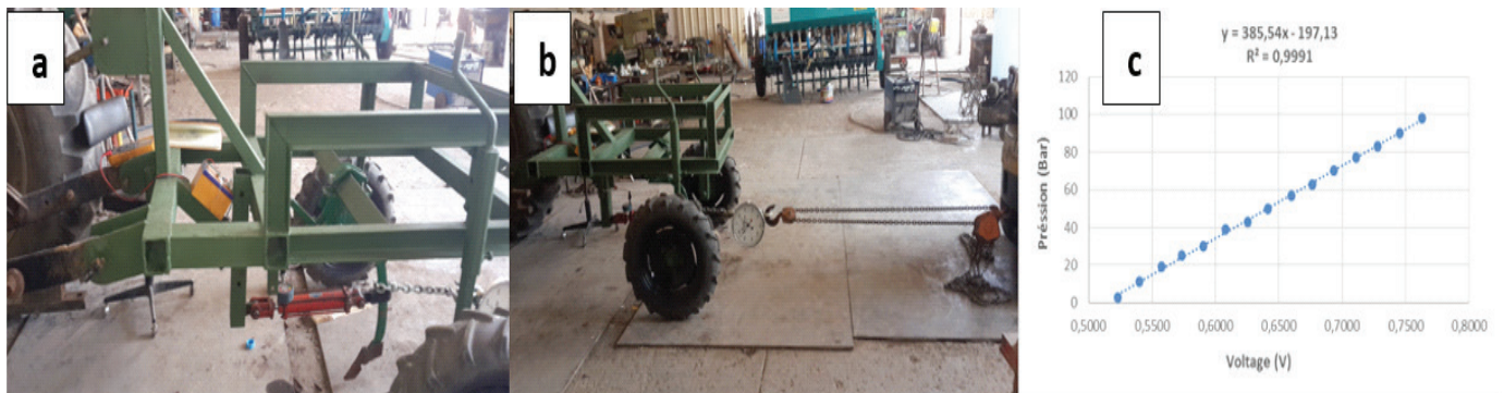
Figure 2: a) Kit de pénétromètre horizontal monté sur un châssis muni de soc et de capteur de pression. b) protocole de calibration du capteur de mesure avec un dynamomètre. c) Courbe Bar = f(V) de calibration du capteur
