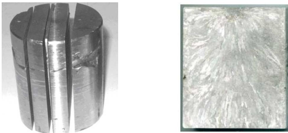
Рис. 2. Разрезанный слиток 08X18H10T с 0,02 вес. %  $ZrO_2 + Y_2O_3$ . (слева), макроструктура центрального темплета слитка (справа).
