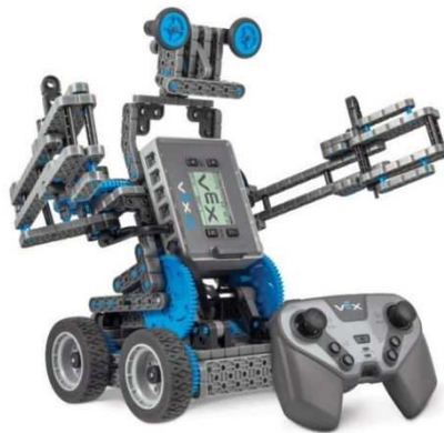
Рис. 16. Робот, створений за допомогою комплекту VexRobotics
