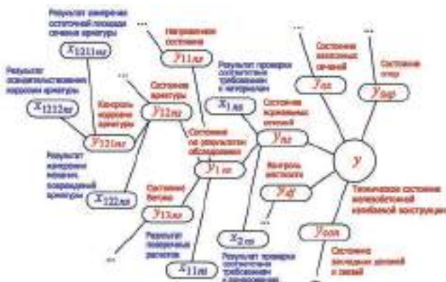
Рис. 4. Фрагмент онтографа «Техническое состояние железобетонной изгибаемой конструкции»
