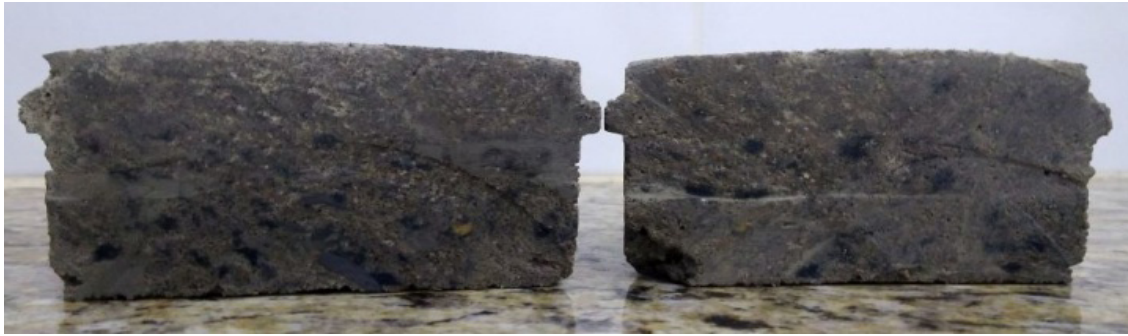
Figura 7. Corte de corpo-de-prova sem adição de cal em estado úmido no interior, após imersão em água (Fonte: os autores).
