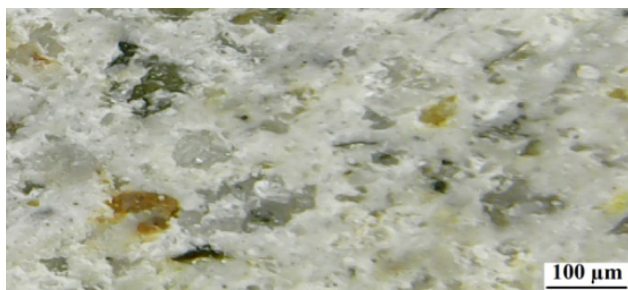
Figura 11. Microscopia dos corpos de prova com aglomerante composto de 50 % cimento e 50 % cal com fator água aglomerante 0,4 (acima) e 0,6 (abaixo) (Fonte: os autores).
