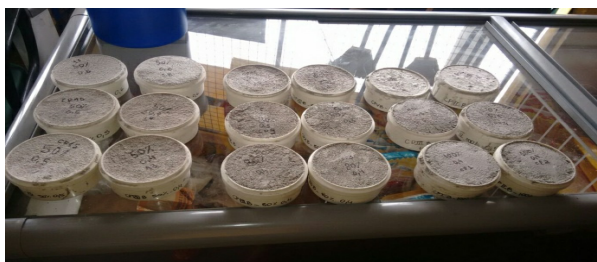
Figura 3. Lote de corpos-de-prova para ensaio de permeabilidade com os traços elaborados. (Fonte: os autores).
