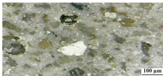
Figura 10. Microscopia dos corpos de prova com aglomerante composto de 80 % cimento e 20 % cal com fator água aglomerante 0,4 (acima) e 0,6 (abaixo) (Fonte: os autores).
