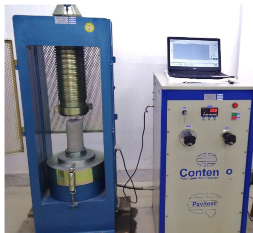
Figura 4. Ensaio de Resistência mecânica à compressão (Fonte: os autores).
