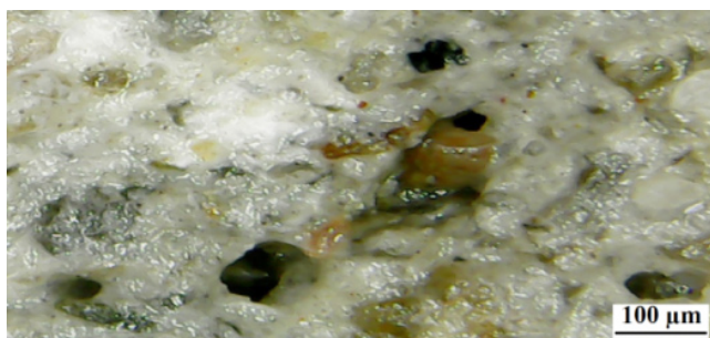
Figura 9. Microscopia dos corpos de prova com 100 % de cimento como aglomerante com fator água aglomerante 0,4 (acima) e 0,6 (abaixo) (Fonte: os autores).
