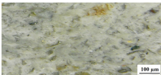
Figura 10. Microscopia dos corpos de prova com aglomerante composto de 80 % cimento e 20 % cal com fator água aglomerante 0,4 (acima) e 0,6 (abaixo) (Fonte: os autores).
