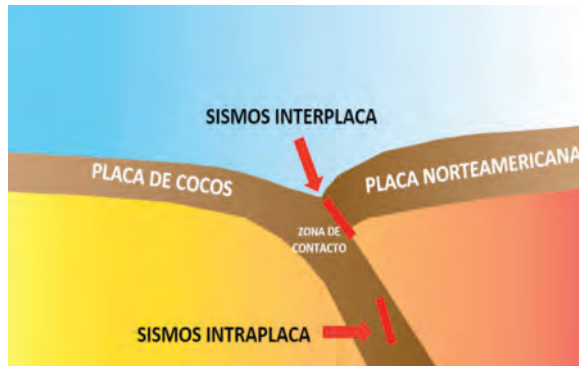
FIGURA 3. ESQUEMA DE LOS SISMOS DE SUBDUCCIÓN DE INTERPLACA Y LOS SISMOS INTRAPLACA
