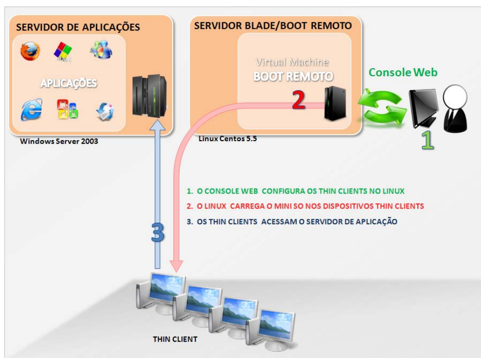
Figura 1. Topologia e o processo de inicialização dos dispositivos Thin Clients usados neste estudo de caso.
