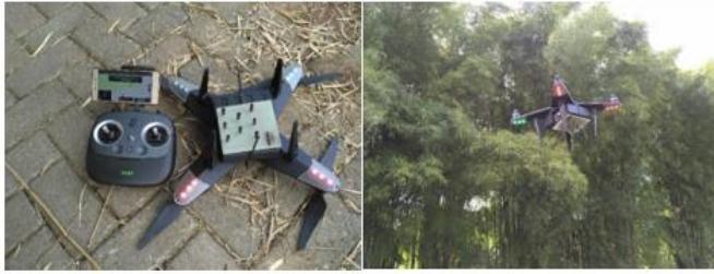
Gambar 13. Pengujian sistem deteksi api menggunakan drone
