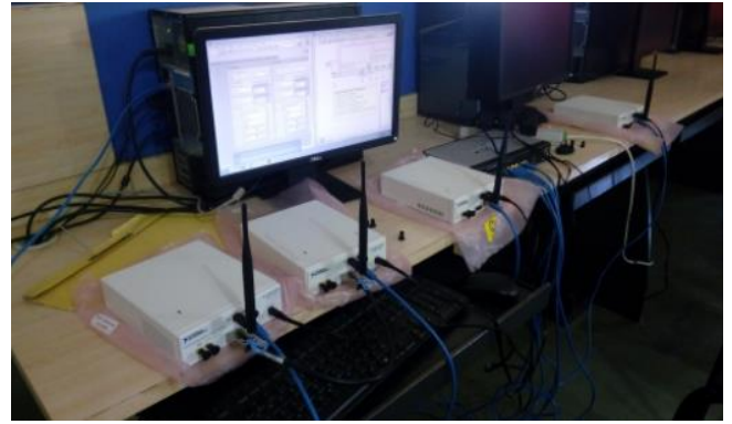
Fig.4. Actual setup for 2x2 MIMO System
