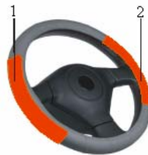
Рис. 1. Рульове колесо з вмонтованими пластинчастими електродами (1-2)
