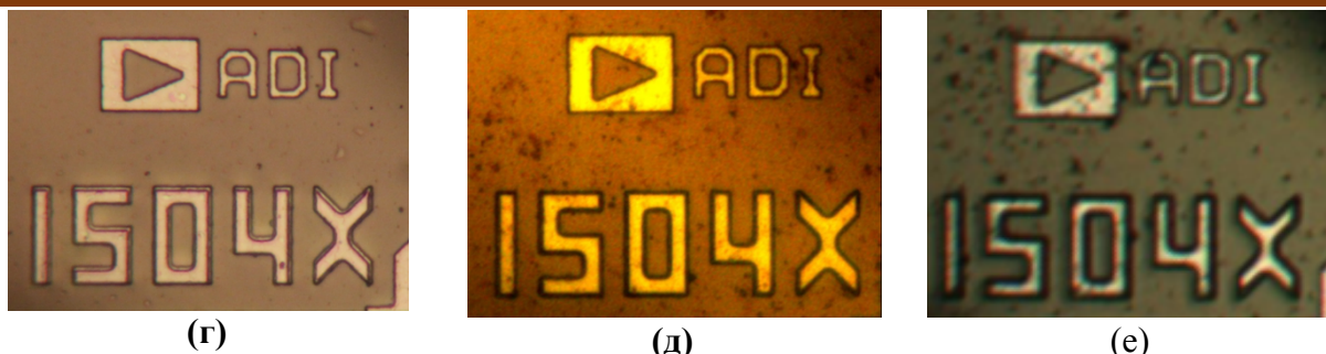
Рис. 7. Сравнение фотографий образца SMP04 и однотипных изделий после вскрытия корпуса (Fig. 7. Comparison photos of SMP04 chip and the same types chips)
