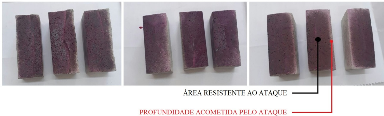
Figura 8. Corpo de prova cimento CP III RS 1 = Fator A/C 0,45; 2 = Fator A/C 0,55; 3 = Fator A/C 0,65.
