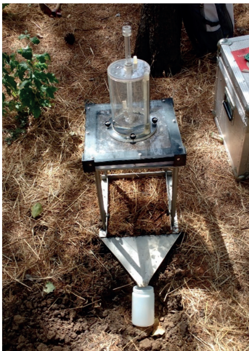
Figura 5. Simulador de chuvas em funcionamento em campo.
