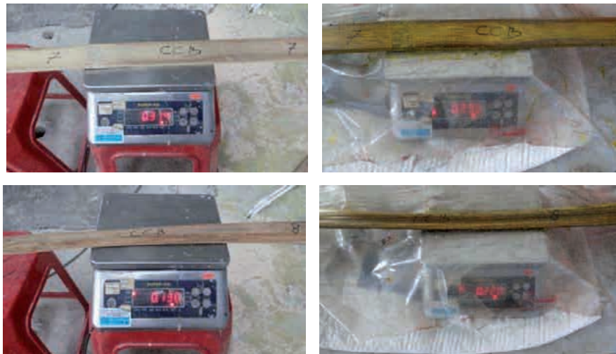
Gambar 3. Perbandingan bambu (atas) dan pelepah gewang (bawah) sebelum diawetkan (kiri) dan setelah diawetkan (kanan) dengan CCB
