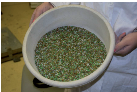
RYSUNEK 2. Słuczka szklana zastosowana w betonie
