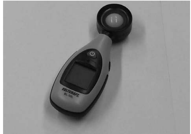
Fig. 9. Voltcraft BL-10L luxmeter
