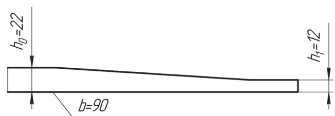
Рис. 3. Эскиз одной ветви полосы малолистовой рессоры
