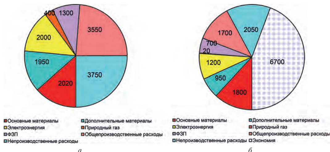
Рис. 4. Сравнение себестоимости 1 т литья из серого чугуна, изготовленного по различным технологиям: a – в настоящее время; б – по прогнозу при использовании новых технологий и повышении точности литья, его масса должна уменьшиться в 2 раза
