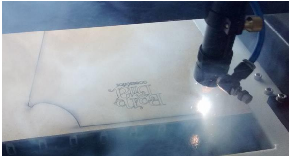
Figura 14: Processos produtivos automatizados: exemplo do uso do corte a laser.
