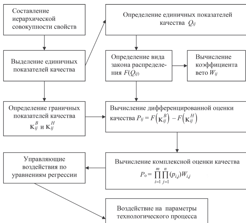
Рис. 2. Схема работы по контролю и анализу уровня качества и технологии
