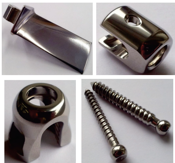
Рис. 11. Примеры электролитно-плазменного полирования изделий из титанового сплава BT6 (Grade 5)
