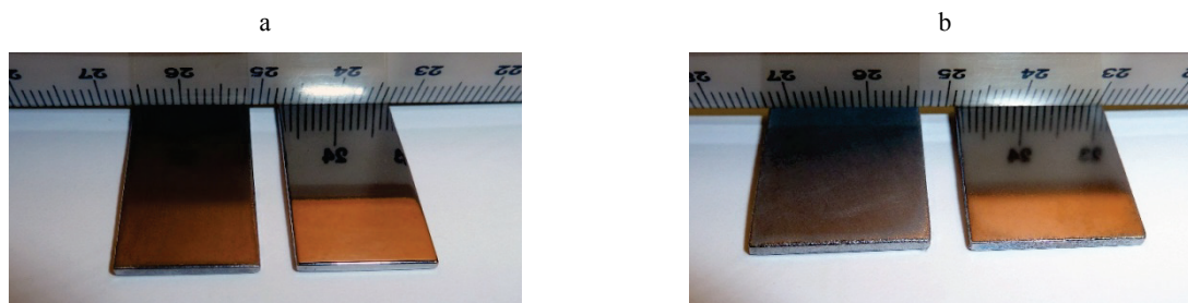
Рис. 3. Внешний вид образцов титана (а) и ниобия (б) до и после электролитно-плазменного полирования
