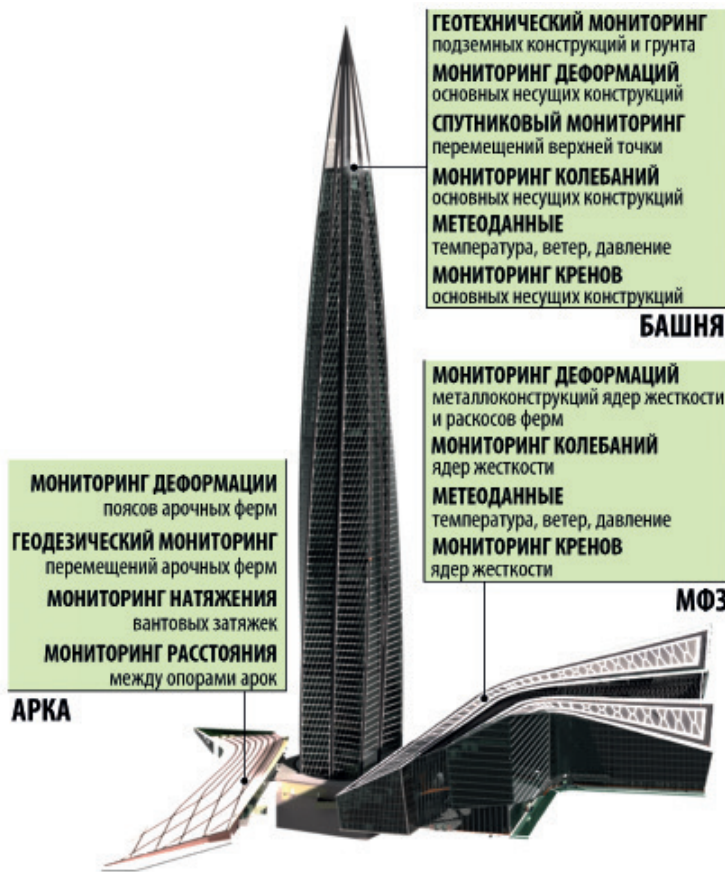
Рис. 1. Система автоматизированного мониторинга МФК «Лакhta Центр»
