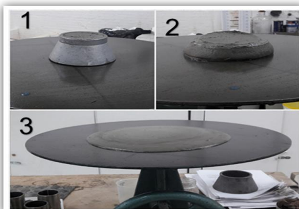
Figura 4. Ensaio do Índice de Consistência da Argamassa
