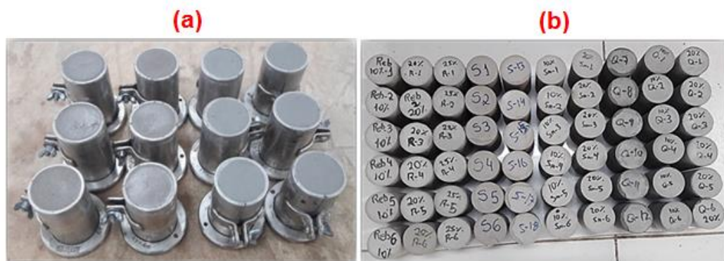
Figura 5. Moldagem dos Corpos de Prova (a); Aparência Fial dos Corpos de Prova (b)
