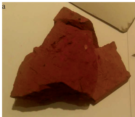
RYSUNEK 1. Odpadowe materiały ceramiczne: a – w formie odpadu; b – w formie kruszywa grubego (opracowanie własne)
