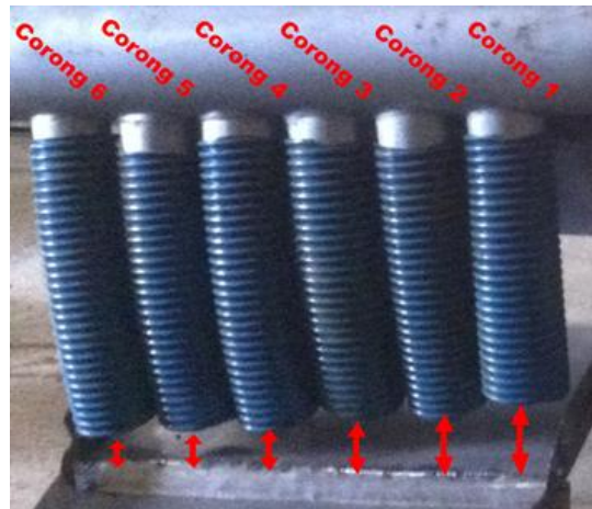
Gambar 2. Posisi corong hisap mesin pemisah potongan tangkai dan daun teh
