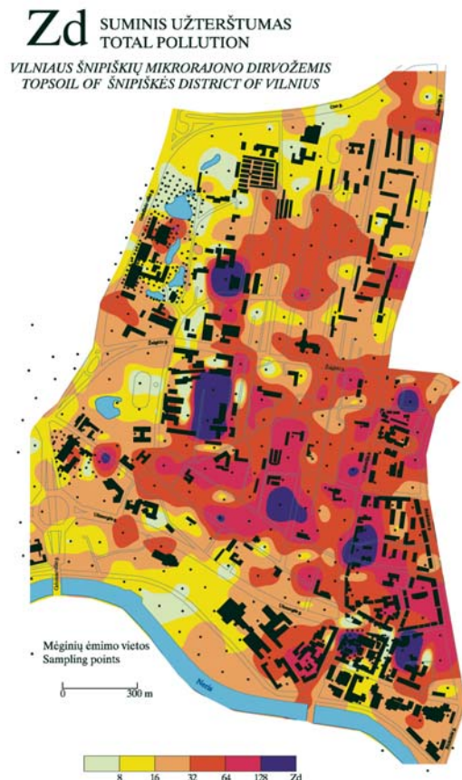
1 pav. Vilniaus Šnipiškių mikrorajono dirvožemių užterštumas sunkiaisiais metalais pagal Z_d rodiklį [6]
