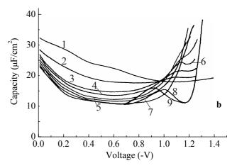
a)  $C_{\text{Te} \{IV\}} = 2 \cdot 10^{-4}$ ;  $C_{\text{dipy}}$ : 1, 2 – 0; 3 – 4 · 10 - 5 M; 5 – 2 · 10 - 4 M; 6 – 3.8 · 10 - 4 M; 7 – 7.4 · 10 - 4 M; 8 – 1.5 · 10 - 3 M; 9 – 2.8 · 10 - 3 M; 10 – 4.4 · 10 - 3 M.
