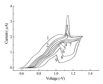
$$\begin{split} &C_{\text{Te (IV)}}\!=2.0\cdot10^{\text{-4}}\text{M. }C_{\text{dipy}}\!\!:1-0;\,2-4\cdot10^{\text{-5}};\,3-1\cdot10^{\text{-4}};\,4-\\ &2\cdot10^{\text{-4}};\,5-3.8\cdot10^{\text{-4}};\,6-7.4\cdot10^{\text{-4}};\,7-1.5\cdot10^{\text{-3}};\,8-2.8\cdot10^{\text{-3}};\\ &9-4.4\cdot10^{\text{-3}}. \end{split}$$
