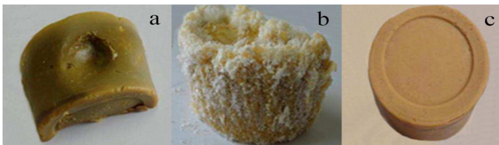
Figura 1- Sabões produzidos com polpa de abacate a partir de diferentes formulações. a) 70 % de polpa, 9 % de resíduo de óleo comestível e 10 % NaOH; b) 50 % de polpa, 24 % de resíduo de óleo comestível e 15 % NaOH e c) 50 % de polpa, 29 % de resíduo de óleo comestível e 10 % NaOH.
