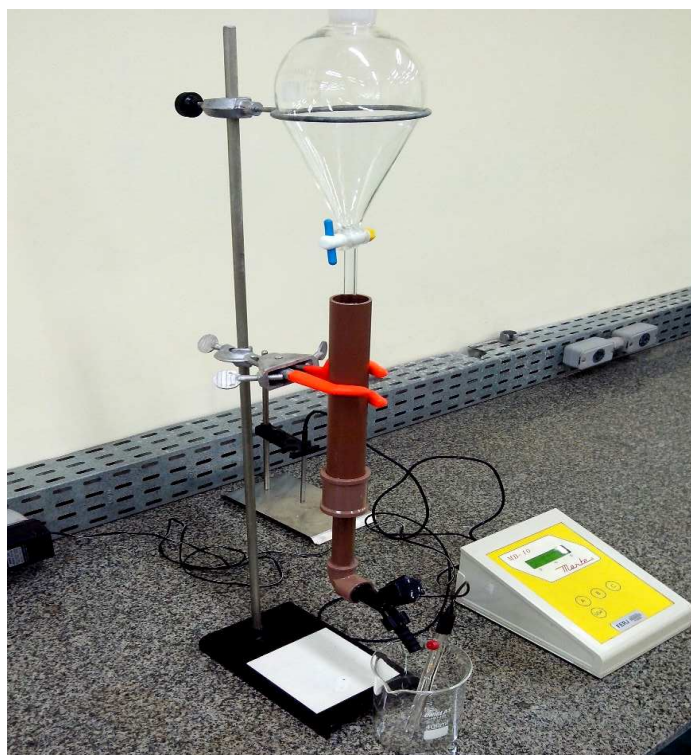
Figura 2 – Unidade para adsorção em leito empacotado.
