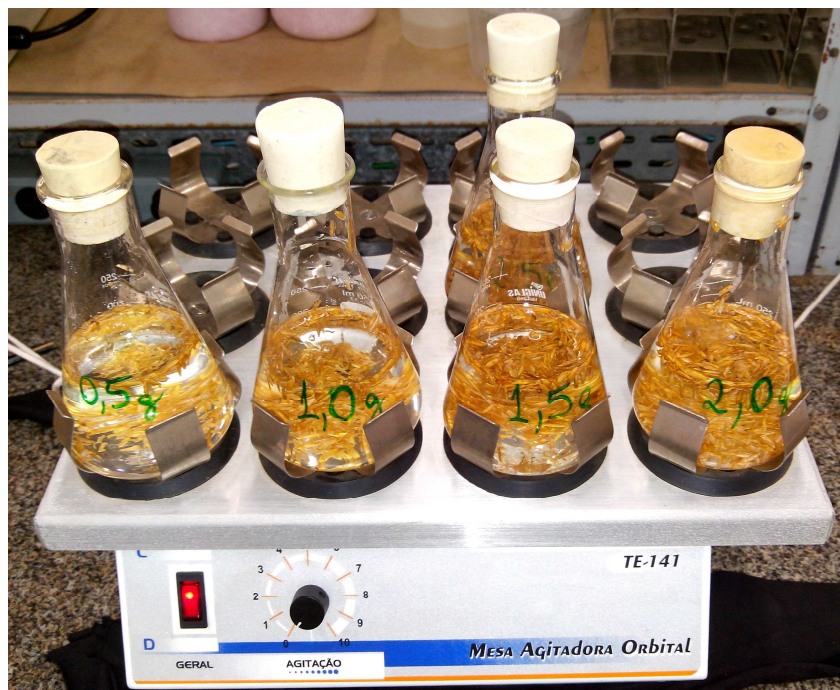
Figura 1 – Amostras de casca de arroz sob agitação em solução de \text{CaCl}_2 .
