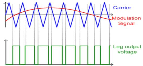
**Fig. 2.** PWM Principle
