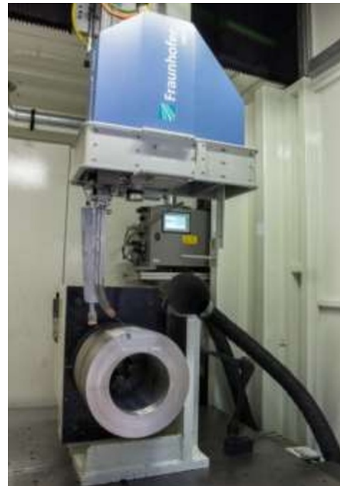
Fig. 2. remoweld ® MPNG weld head prototype
