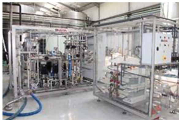
**Figure 2.** Installation de stabilisation tartrique du vin par électrodialyse. Capacité 120 hl/h (Source : Oenodia).
