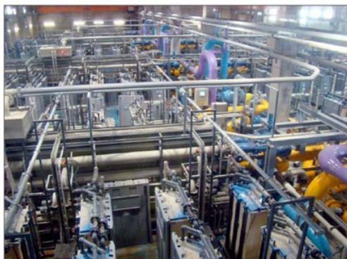
**Figure 5.** Installation de traitement d'eau par électrodialyse – Capacité 220 000 m<sup>3</sup>/jour (Source : GE Water).
