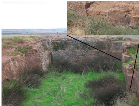
Fig. 8. Cantera en la meseta del Castellón y agujeros para cuñas preparadas para la extracción de grandes bloques de arenisca. Foto: PAEJ, 2012.
