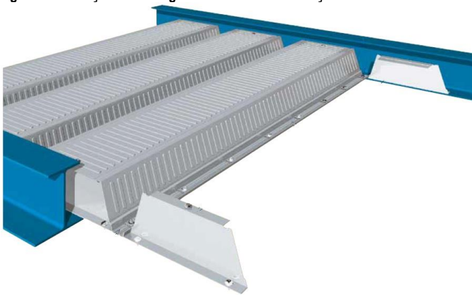
Figura 12 – Fixação do diafragma final e da fôrma de aço
