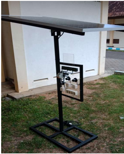
Gambar 6. Model PLTS dengan micro inverter .
