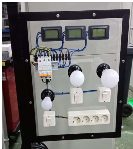
Gambar 7. Panel pada model PLTS dengan micro inverter .
